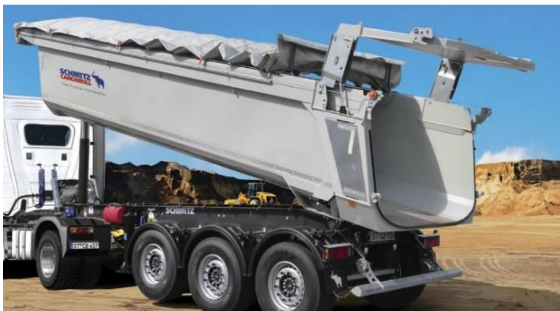
1 pav. Puspriekabė kietųjų žaliavų/produktų pervežimui
