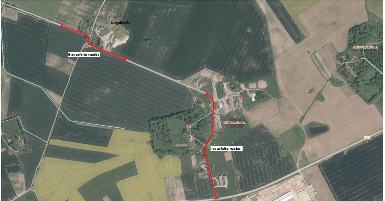
3 pav. Preliminari planuojamų asfaltuoti kelio atkarpų schema
