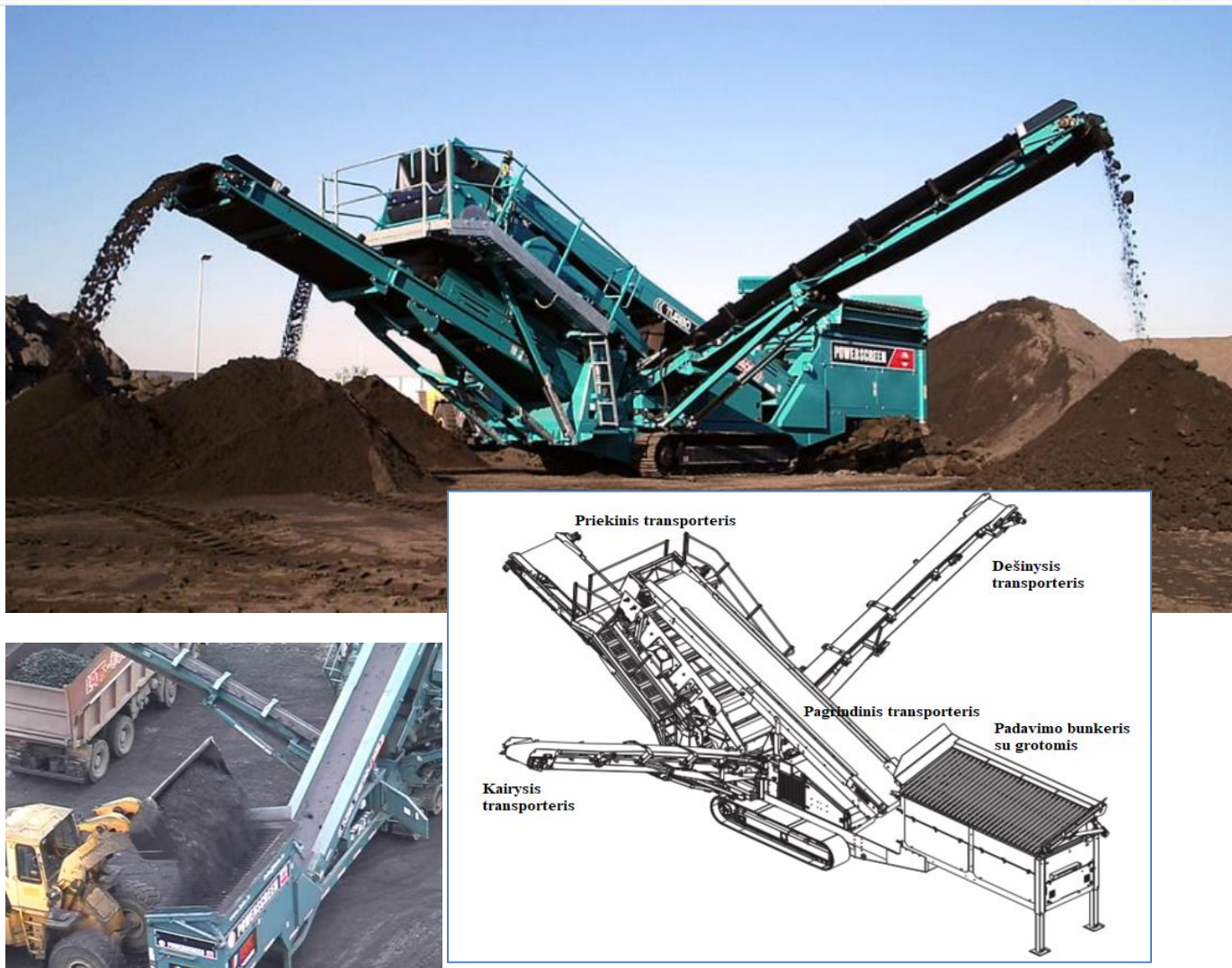
5 pav. Mobilus vibrosietas Powerscreen Chieftain 1400
