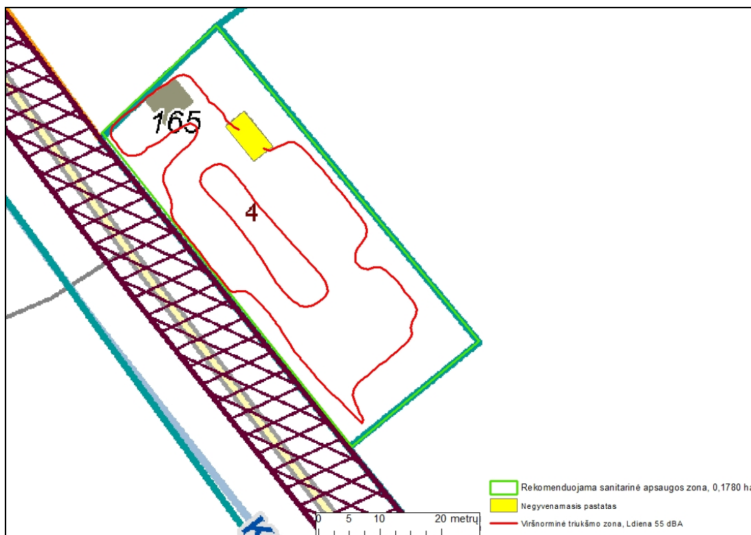
15 pav. Rekomenduojama sanitarinė apsaugos zona su triukšmo lygių viršijimo izolinijomis
