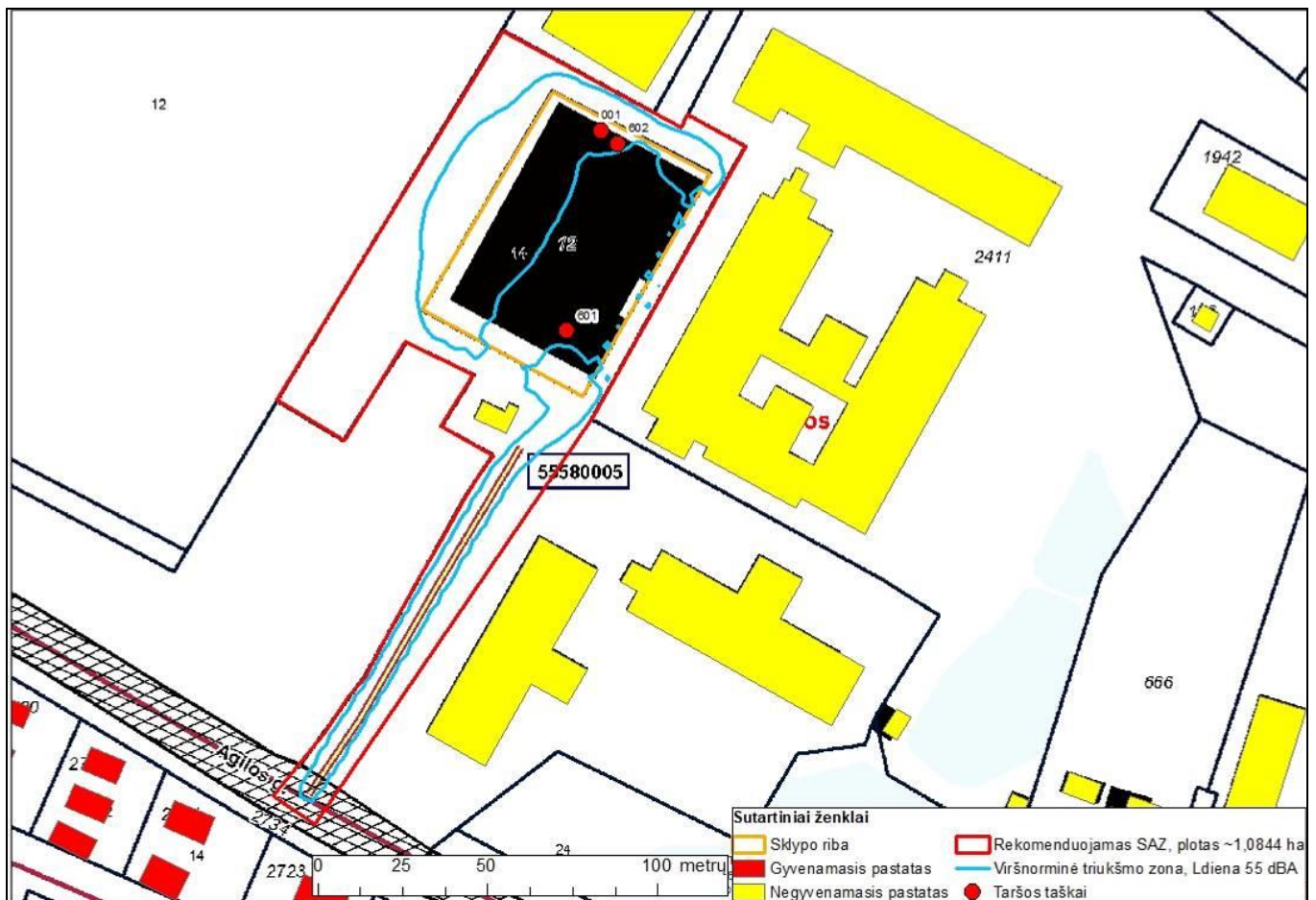
14 pav. Rekomenduojama sanitarinė apsaugos zona su triukšmo lygių viršijimo izolinijomis
