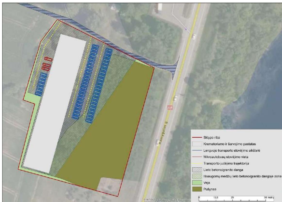
2 pav. Planuojami statiniai, įrenginiai, aikštelės
