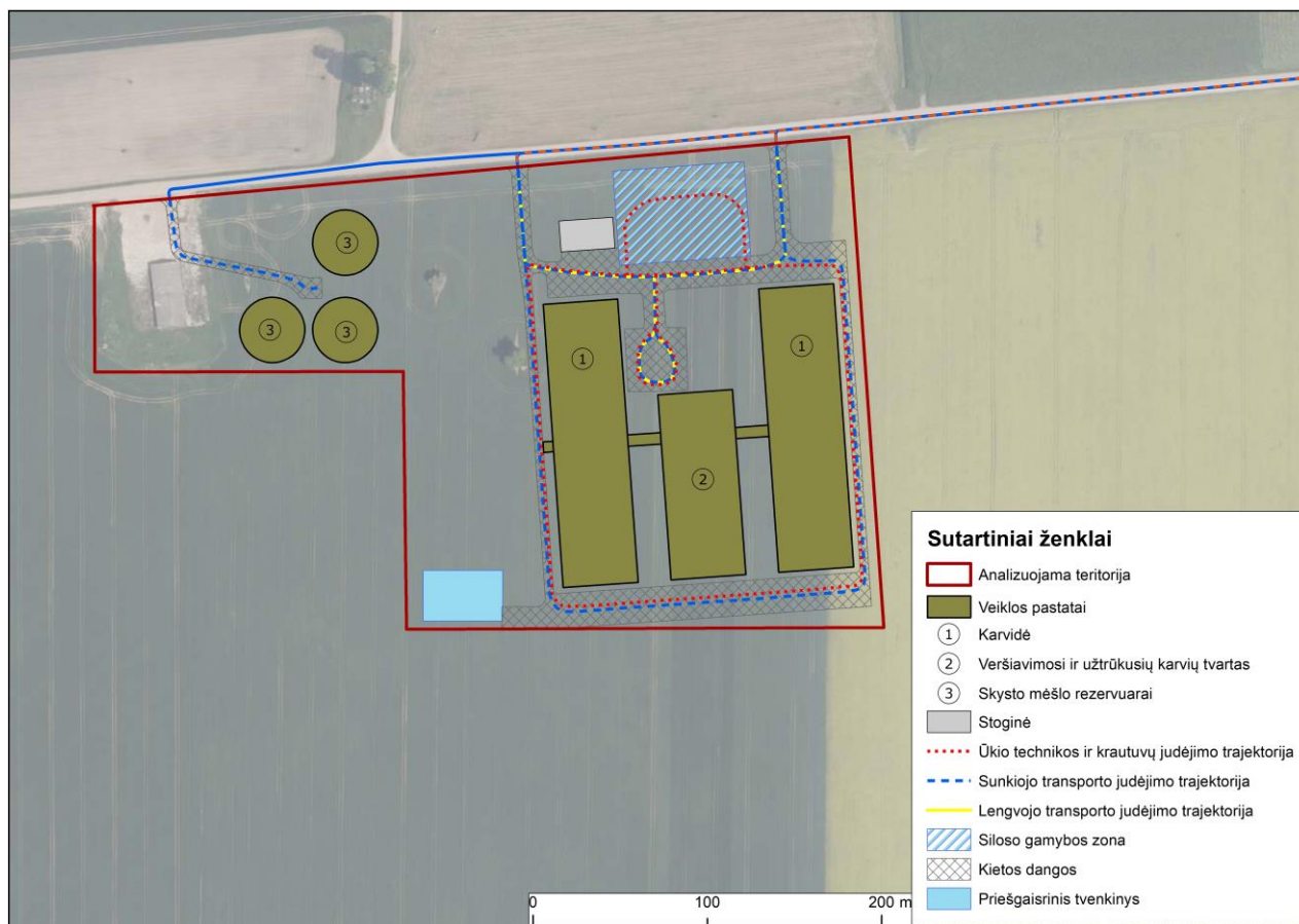
1 pav. Planuojami statiniai, įrenginiai, aikštelės
