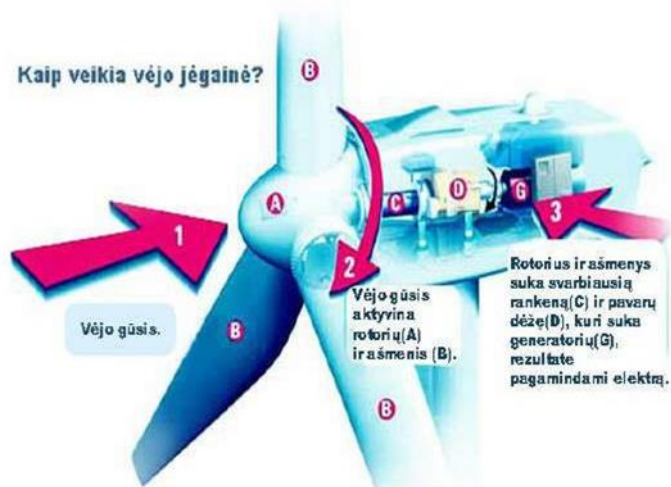
8 pav. Vėjo jėgainės konstrukcija ir veikimo principas
