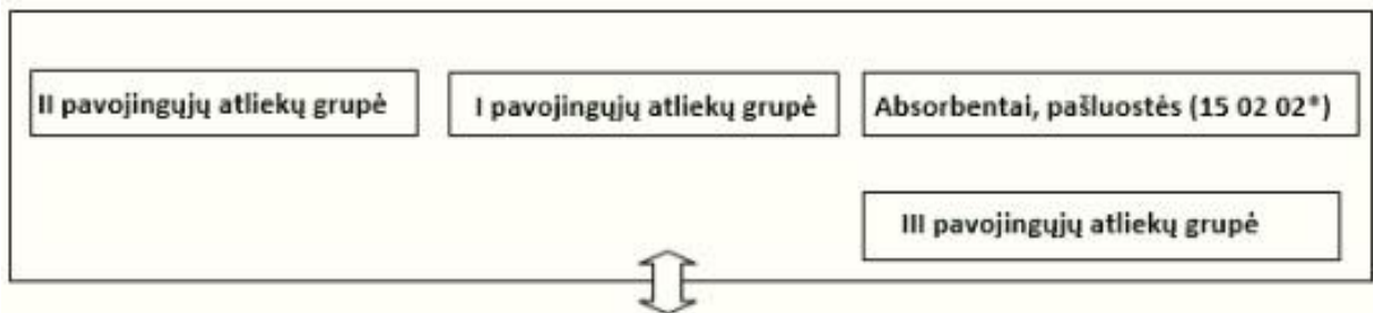
4 pav. Pavojingųjų atliekų išdėstymo sandėlyje schema
