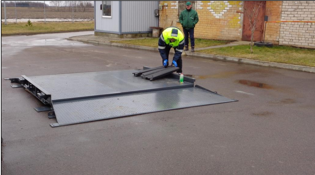
2 pav. Automobilinės svarstyklės DINI ARGEO DFWL
