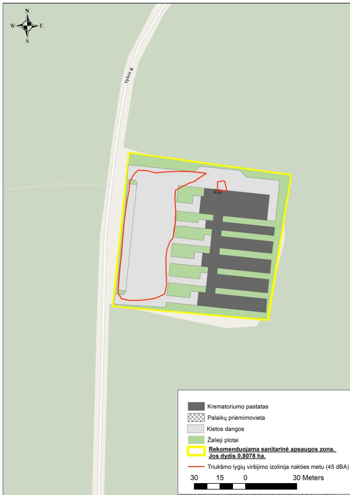
5 pav. Rekomenduojama sanitarinė apsaugos zona su triukšmo lygių viršijimo izolinija nakties metu (45 dBA)
