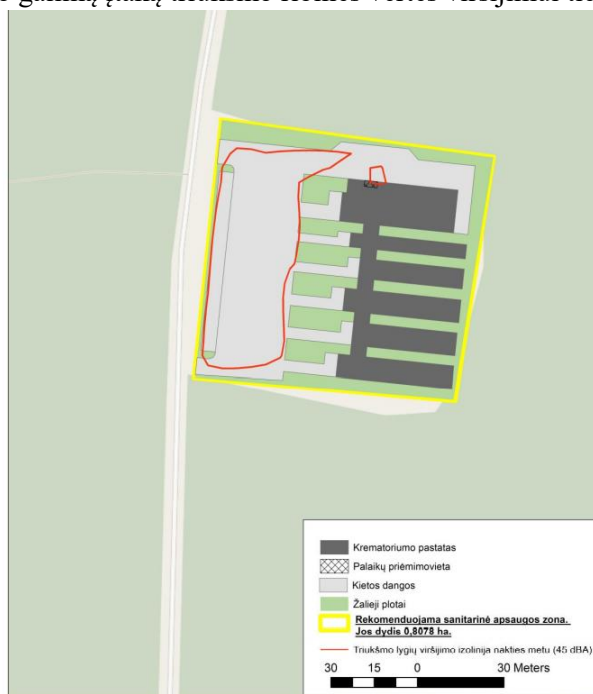
16 pav. Rekomenduojama sanitarinė apsaugos zona su triukšmo lygių viršijimo izolinija nakties metu (45 dBA)
