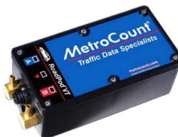
2 pav. Matavimo įrenginys MetroCount VT 5900
