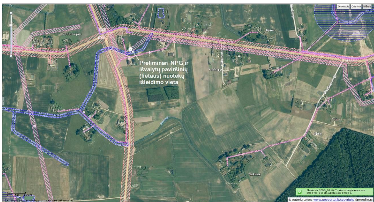
7 pav. Preliminari paviršinių (lietaus) nuotekų valymo įrenginio - naftos produktų gaudyklės (NPG) ir išvalytų paviršinių (lietaus) nuotekų išleidimo vieta.
