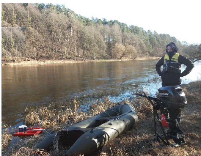
5.3 pav. Matavimo profilio ruožas ir pasirengimas upės debito, greičių ir gylių matavimams. Fotografuota nuo dešiniojo kranto.
