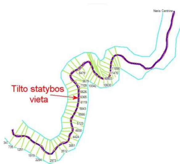
6.4.1 pav. Modeliuojamo ruožo schema ir skerspjūvių piketai (HEC-RAS). Tilto statybos vieta piketas – 6365.
