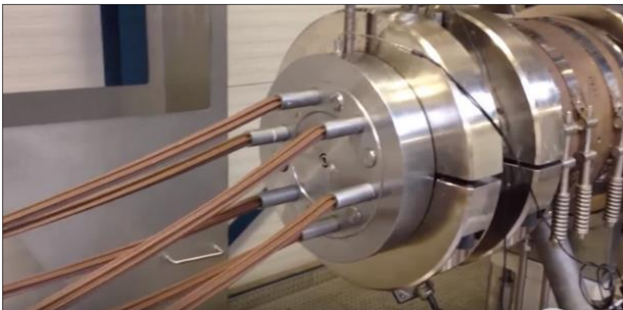
3 pav. Iš ekstruderio per matricą su tam tikro profilio antgaliais išspaudžiami vientisi ruošiniai nukreipiami ant juostinio konvejerio
