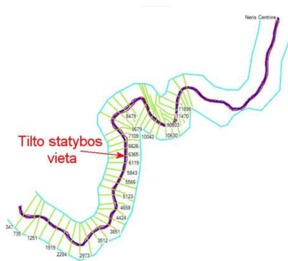
6.4.1 pav. Modeliuojamo ruožo schema ir skerspjūvių piketai (HEC-RAS). Tiltu statybos vieta piketas – 6365.
