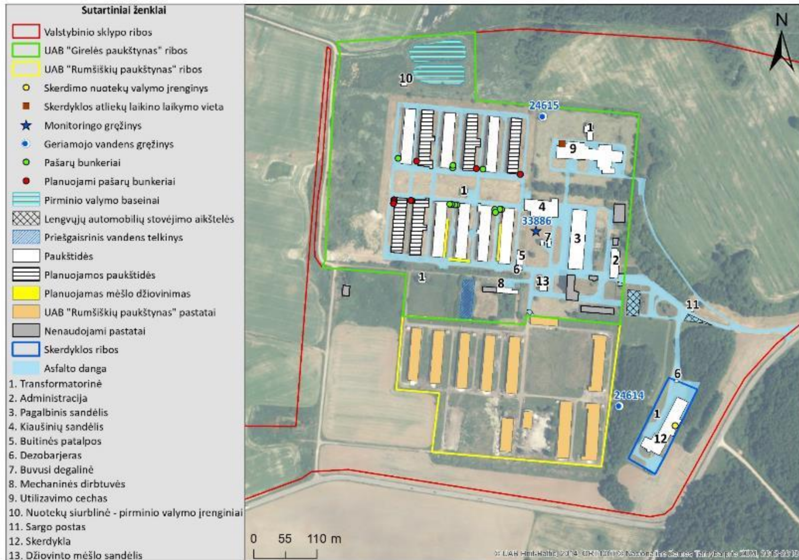
8 pav. UAB „Girelės paukštynas“ gamybinės teritorijos bei esamų ir planuojamų technologinių statinių ir įrenginių išdėstymo planas
