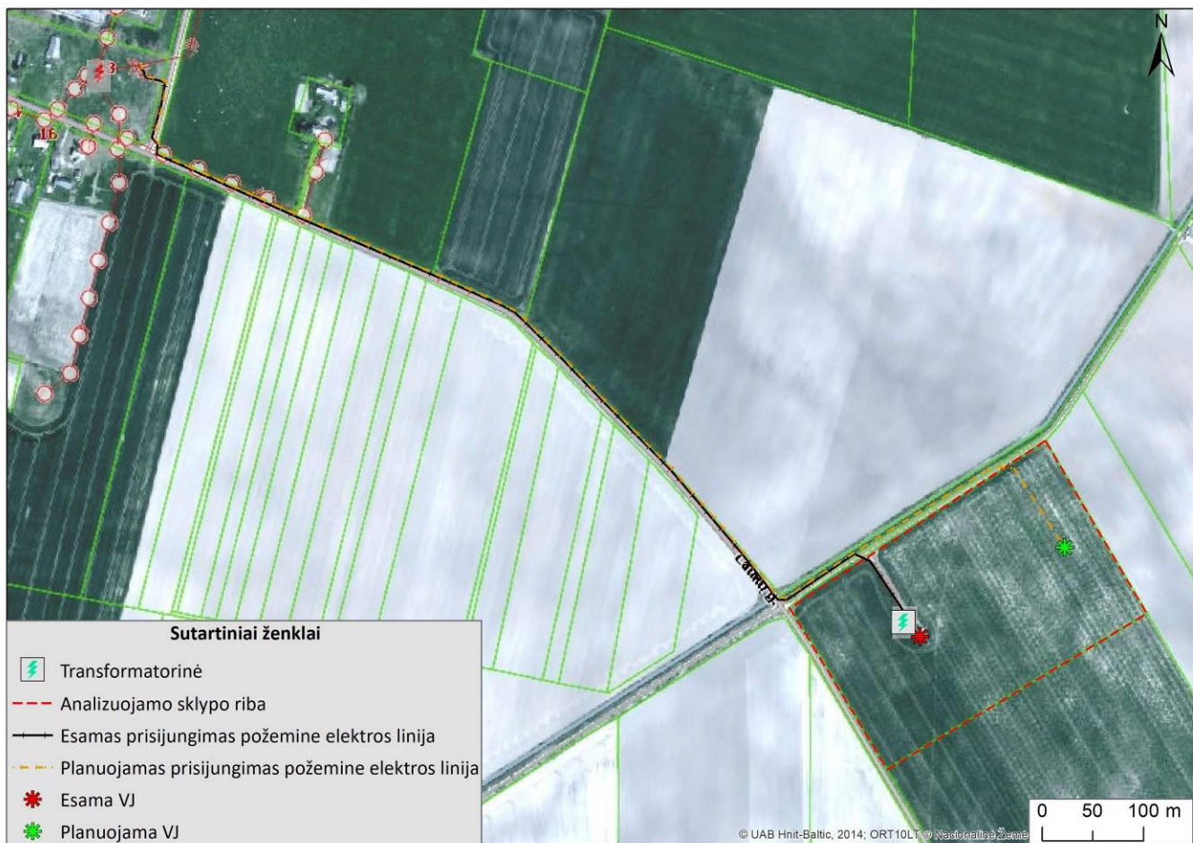
2 pav. Esamas ir planuojamas elektros prisijungimas požemine elektros linija
