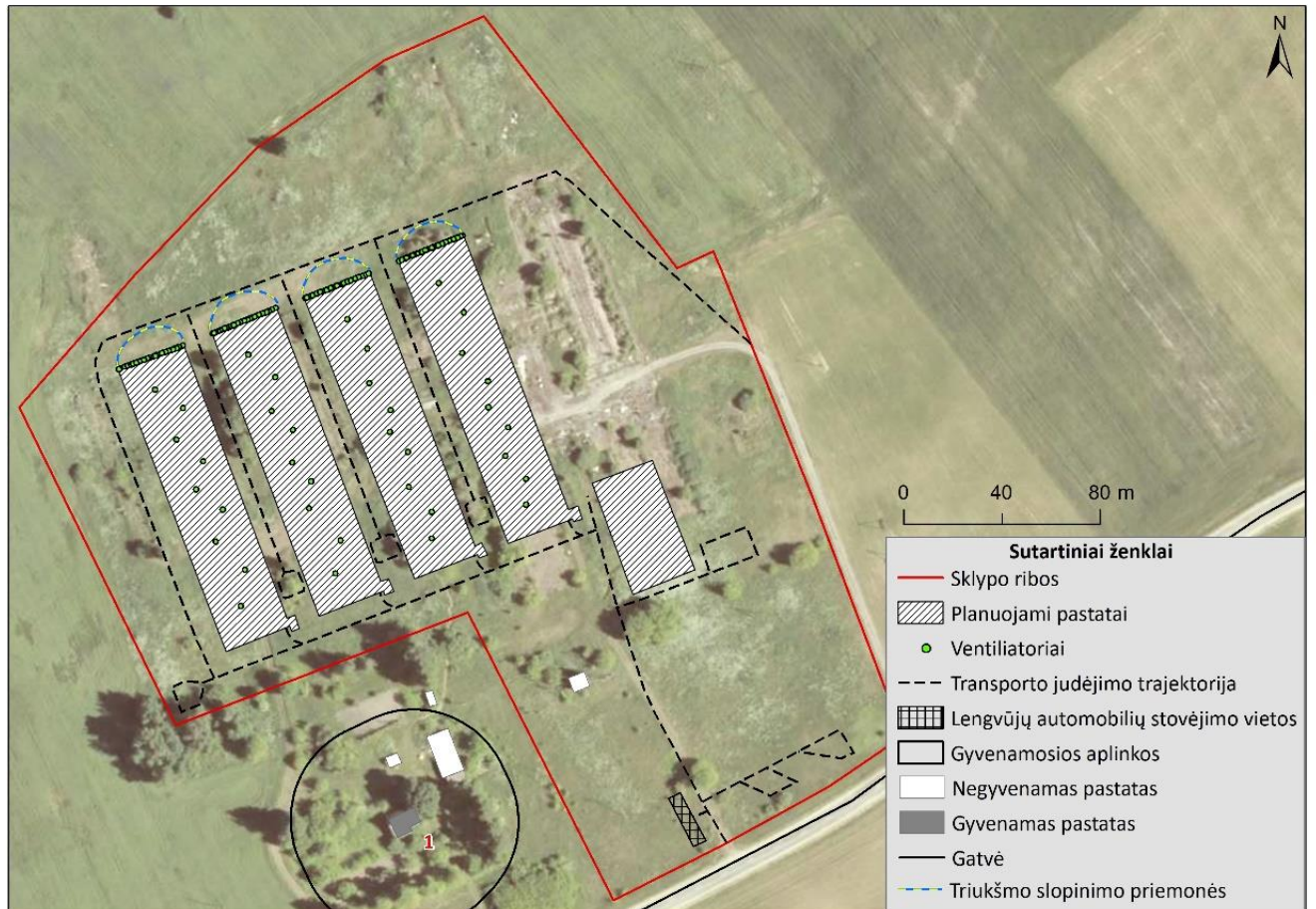
35 pav. Situacijos schema su rekomenduojamomis triukšmo slopinimo priemonėmis
