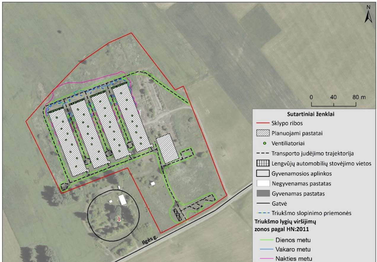
36 pav. Sumodeliuotas projektinės situacijos triukšmo sklaidos žemėlapis analizuojamoje teritorijoje, be foninių triukšmo šaltinių su triukšmo slopinimo priemonėmis
