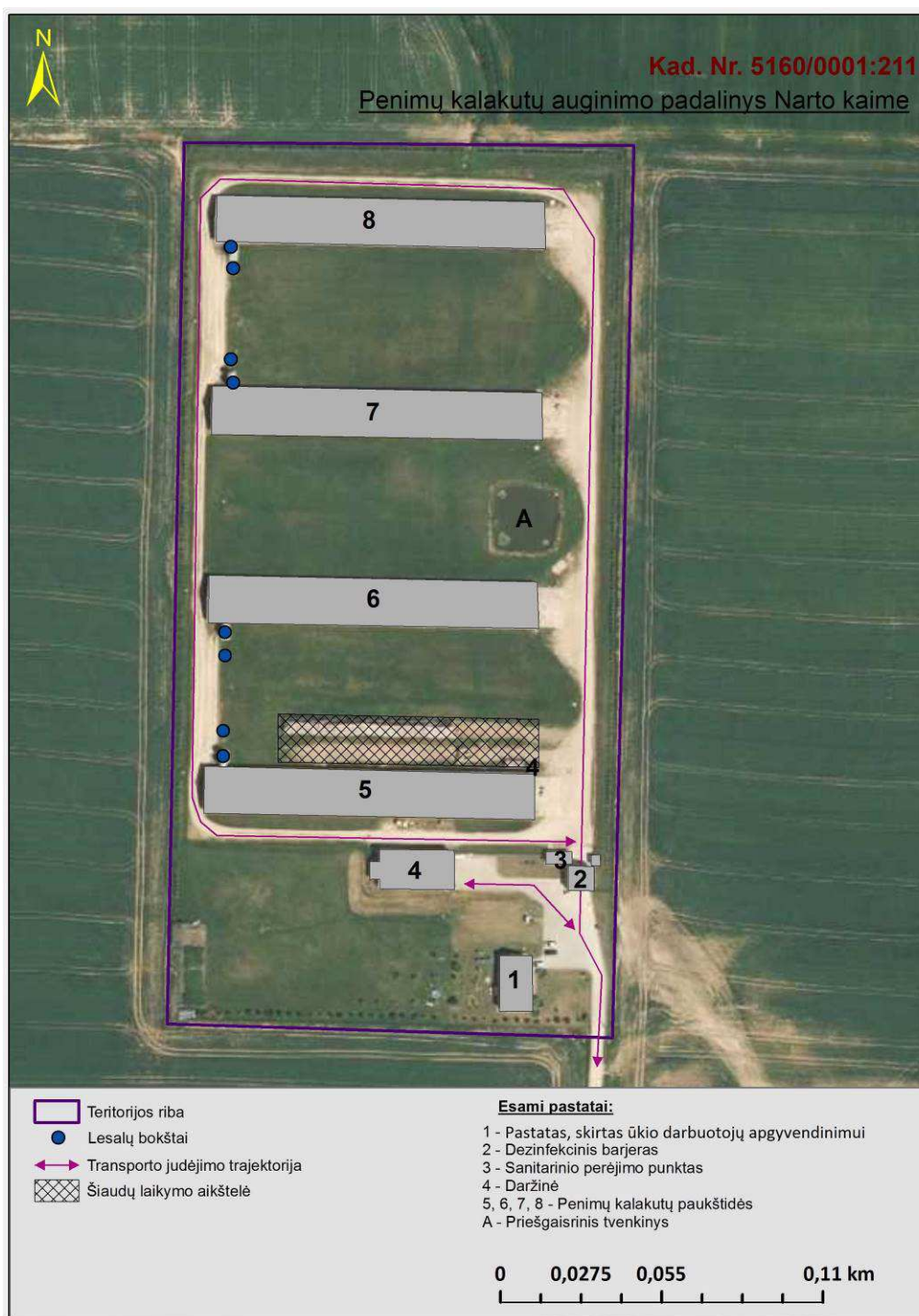
4 pav. Penimų kalakutų ūkio, esančio sklype, kurio kadastrinis Nr. 5160/0001:211, esamų statinių išdėstymo ir transporto judėjimo schema
