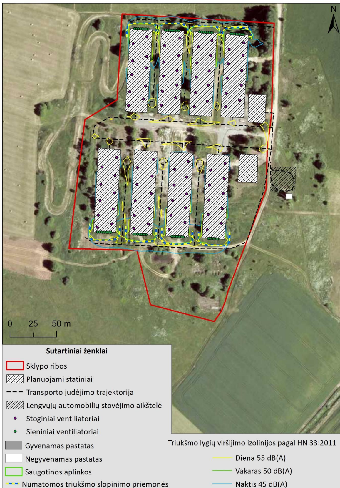
37 pav. Sumodeliuota projektinės situacijos triukšmo sklaida (atvaizduota izolinijomis), be foninių triukšmo šaltinių su triukšmo slopinimo priemonėmis
