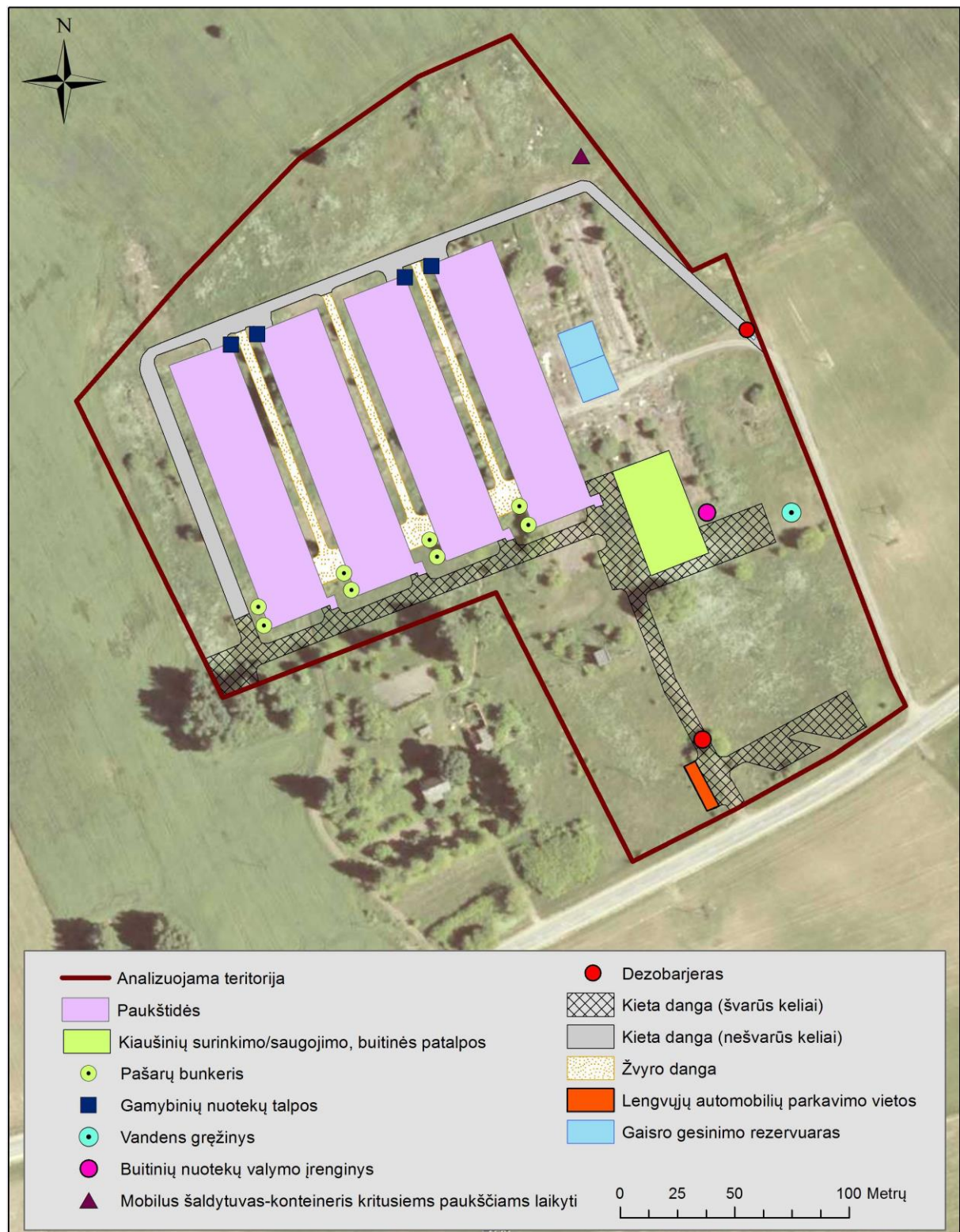
5 pav. Planuojamų statinių, įrenginių, aikštelių išsidėstymo schema
