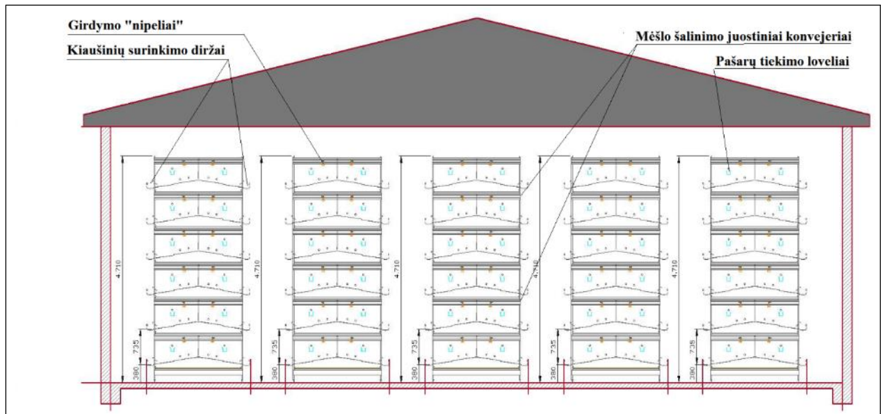
6 pav. Vištų laikymo narvų išdėstymo vištidėje pavyzdys
