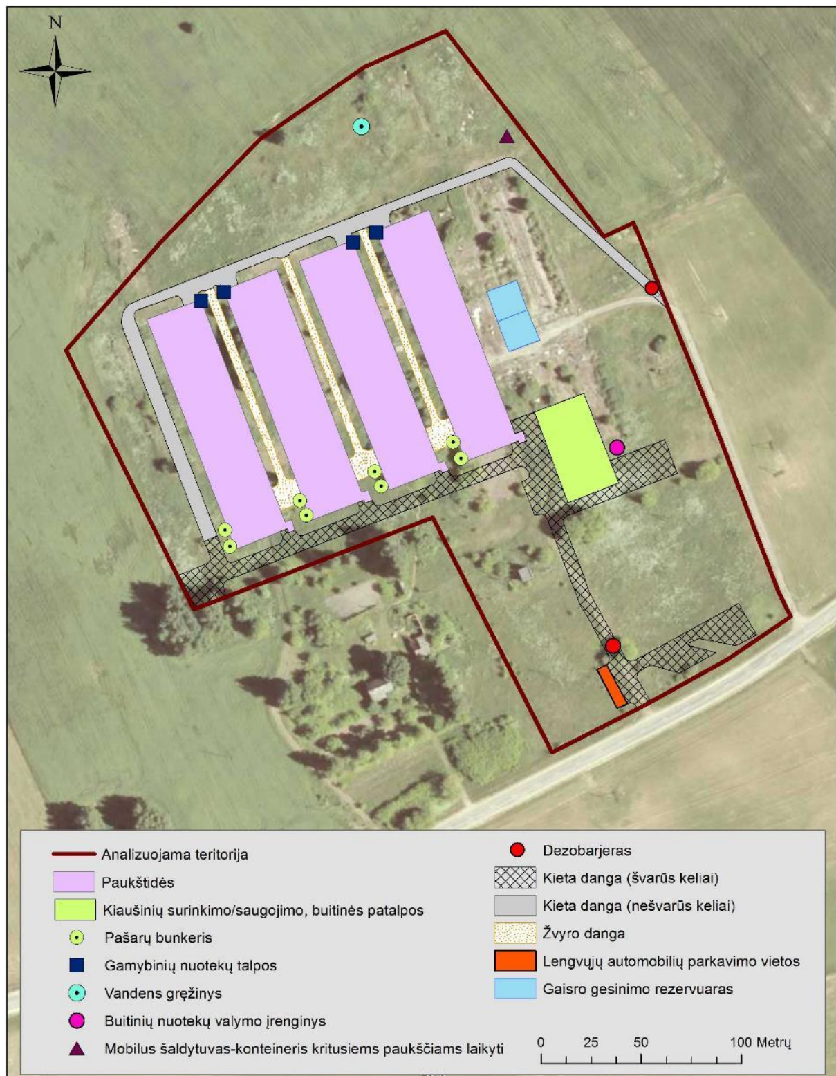
1 pav. Planuojamų statinių, įrenginių, aikštelių išsidėstymo schema
