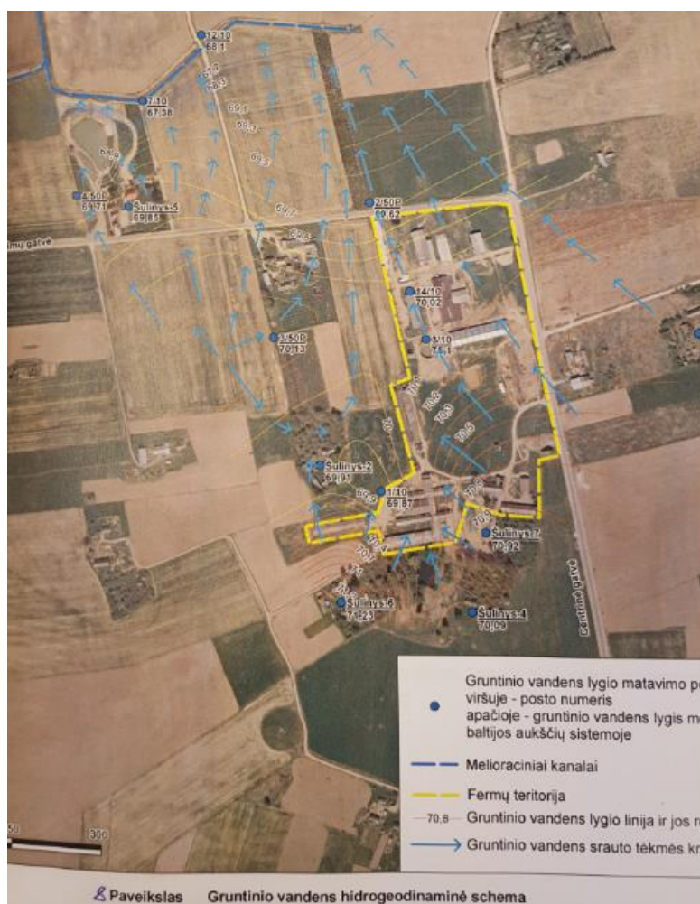
11. pav. PŪV teritorijos ir apylinkių gruntinio vandens srauto hidrogeodinaminė schema. Šaltinis: Lietuvos geologijos tarnybos ataskaita „Gyvulininkystės komplekso poveikio požeminio vandens būklei vertinimas Margininkų k.“ 2011 m.
